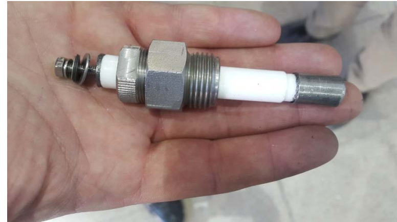
نام محصول: سنسور مقاومت سنج در داخل راکتور اب و بخار به منظور دانستن ارتفاع آب کاربرد: در راکتور
